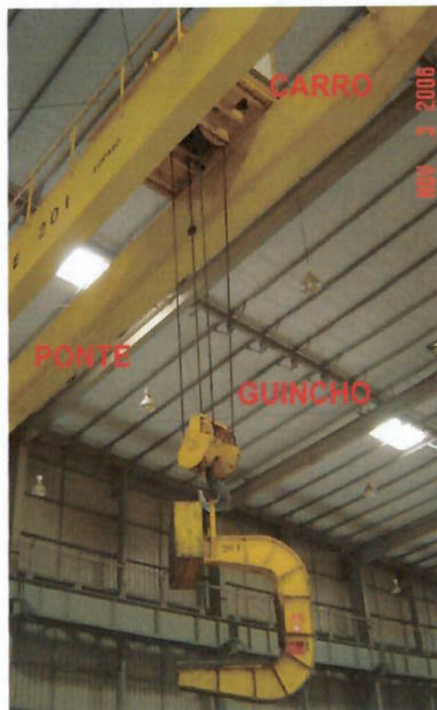
Figura 7: Componentes da Ponte Rolante: Ponte / Carro / Guincho
